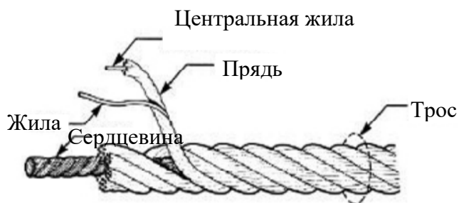
Три основных компонента стального троса
